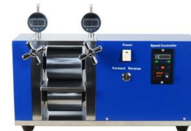
Прецизионный электронный пресс холодной прокатки STC-DDG100
