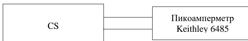
Рисунок 1 – Структурная схема определения абсолютной погрешности воспроизведения силы постоянного тока в диапазоне от 20 нА до 20 мА
